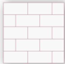
Pose de dalles rectangulaires à joints décalés
