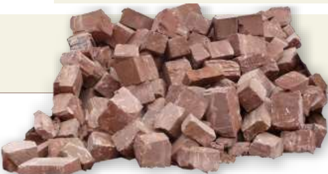
Chutes de blocs équarris
